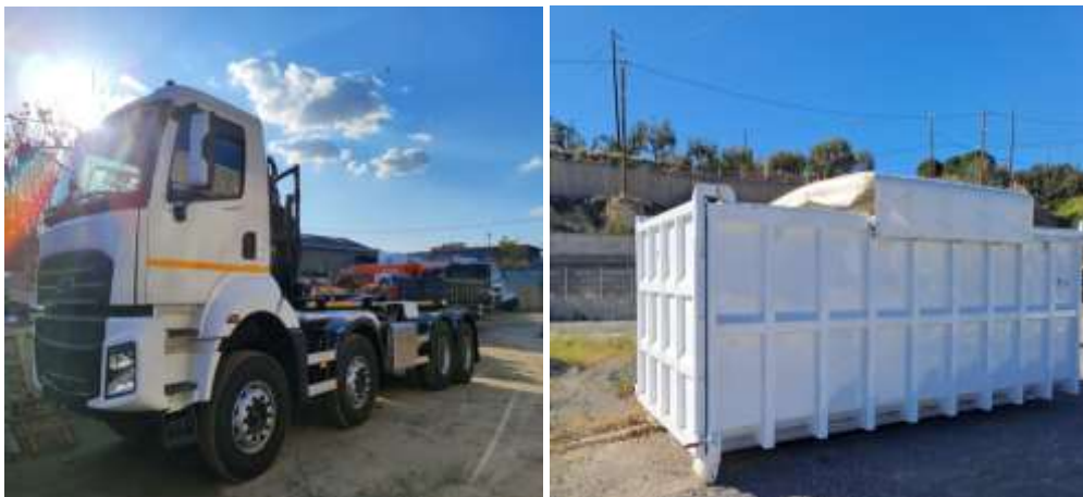
Προμήθεια φορτηγού μεταφοράς κάδων αφυδατωμένης Ιλύος (Hook Lift): (α) φορτηγό μεταφοράς (β) κάδος μεταφοράς αφυδατωμένης λάσπης
