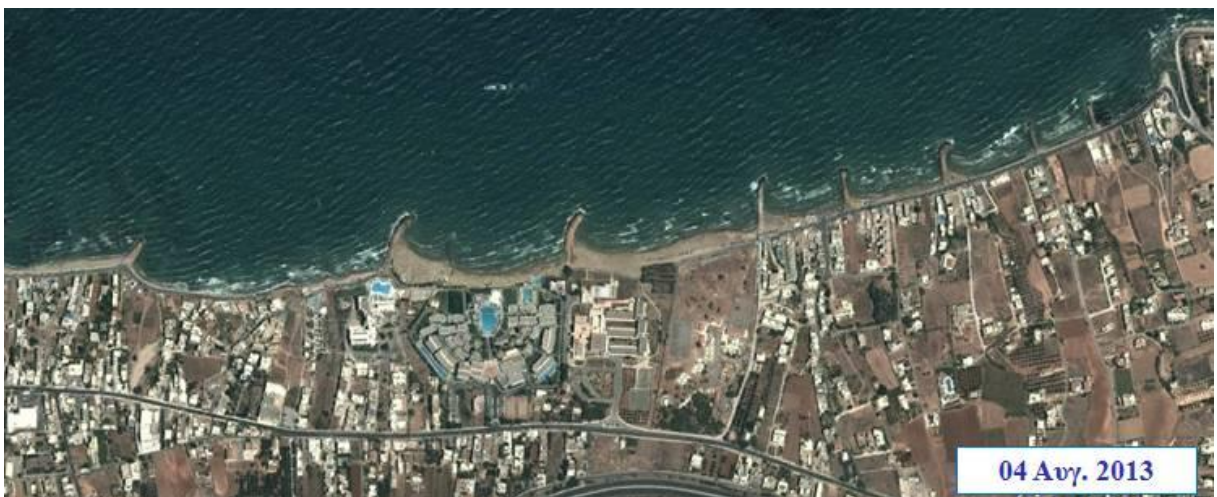
Εικ. 54: Η ακτή της περιοχής Κοκκίνη-Χάνι με τους χαρακτηριστικούς προβόλους προστασίας της ακτής από τη διάβρωση (δορυφορική εικόνα του Αυγούστου 2013).
