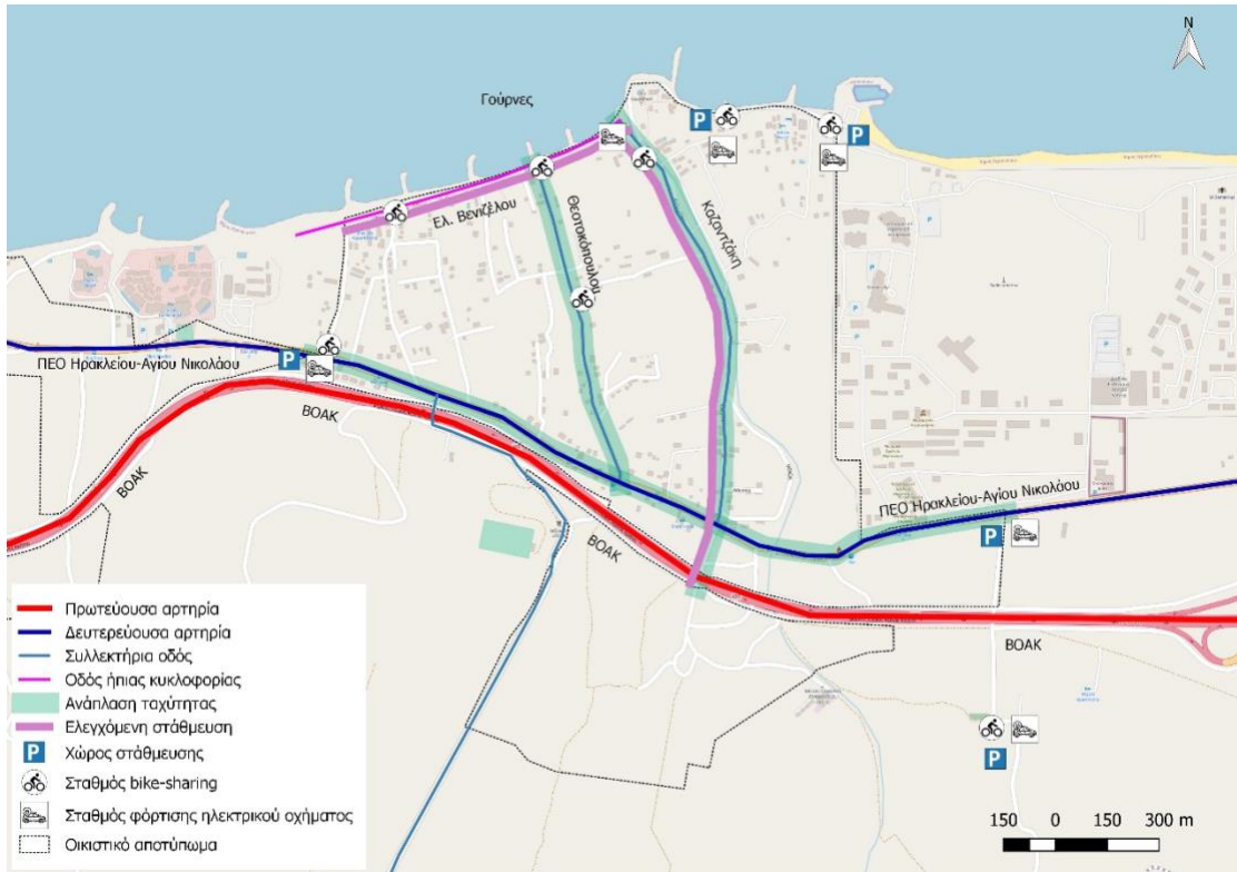
Εικόνα 31: Μείωση ταχύτητας σε κύριο οδικό δίκτυο, ελεγχόμενη στάθμευση, χώροι στάθμευσης, σταθμοί φόρτισης και κοινόχρηστα ποδήλατα (Γούρνες-10ετία)
